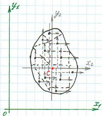
а) В центрах тяжести  $C_i$  фигур, составляющих поперечное сечение, вводим локальные декартовы системы координат  $S_i x_i y_i$ , оси которых параллельны глобальным осям  $x_2$  и  $y_2$ . Они понадобятся ниже при использовании теоремы Штейнера.
