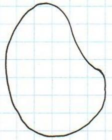
1) Разбиваем сложное поперечное сечение на простые фигуры (треугольник, прямоугольник, круг, полукруг, кольцо), характеристики которых (площадь, положение центра тяжести, моменты инерции) легко подсчитываются.
