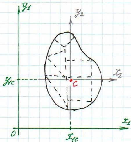
5) В системе  $S_{x_2 y_2}$  вычисляем моменты инерции  $J_{x_2}$ ,  $J_{y_2}$  и  $J_{x_2 y_2}$  поперечного сечения. Для этого:
